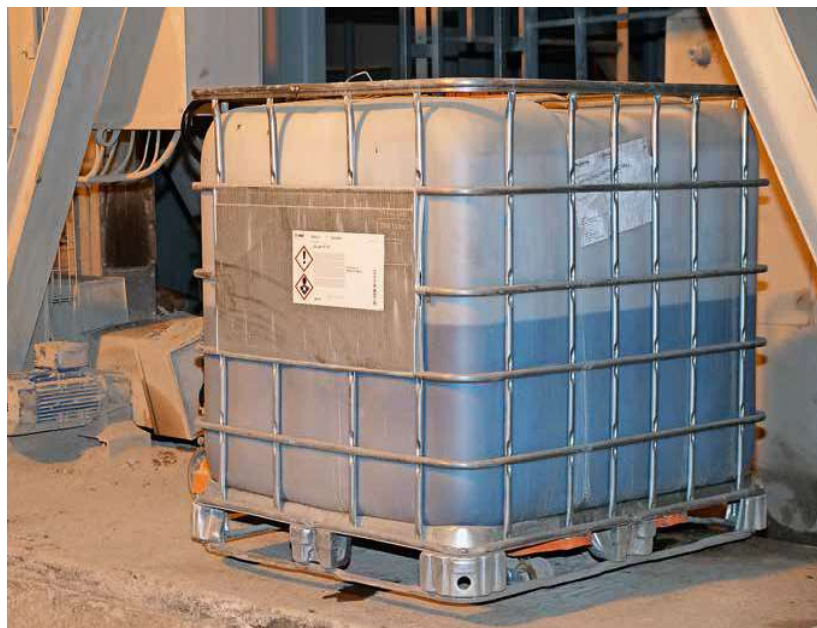
Die Zugabe des Additivs erfolgt aus einem IBC per Additivpumpe direkt in die Bitumenwaage
